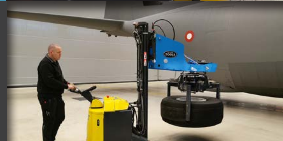
Inclinación de 90° y rotación precisa de +/-25°.
