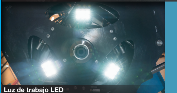
Segunda cámara para una alineación precisa de los pernos
