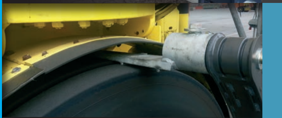
Brazo superior plano para limitar el espacio libre de los neumáticos
