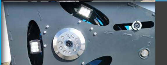
Sistema de 2 cámaras: para alinear cubos y pernos
