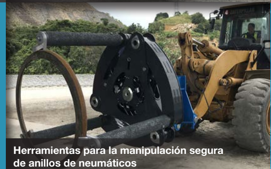
Módulo de inclinación de 35° o 90°: de horizontal a vertical
