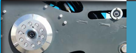
Sistema de 2 cámaras: para alinear cubos y pernos
